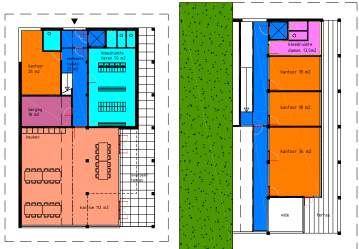
De begane grond is verdeeld in 4 grote ruimtes, de eerste verdieping in 3 kantoren en een dameskleedkamer
